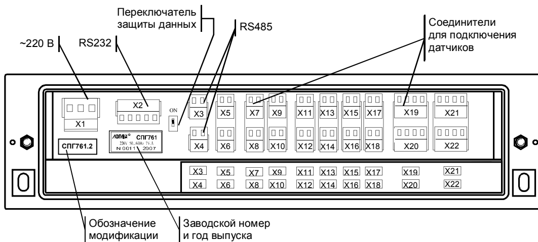
Рисунок 3.2 – Монтажный отсек (крышка снята)
